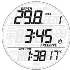
Wenn Sie die obere Taste drücken, erscheint 5 Sekunden lang in der oberen Zeile die Maximaltiefe und die Anzahl der Tauchgänge in der Tauchgangsserie, in der mittleren Zeile die Dauer der Oberflächenpause und in der unteren Zeile abwechselnd der längste Tauchgang der Tauchgangsserie, die maximale Aufstiegs- und Abstiegsgeschwindigkeit der Tauchgangsserie, und die niedrigste während der Tauchgangsserie gemessene Temperatur.
