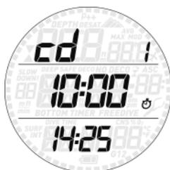
Wenn Sie die obere Taste gedrückt halten, beginnen die Minuten in der mittleren Zeile zu blinken. Durch Drücken der oberen oder unteren Taste können Sie nun den Wert verändern. Zum Bestätigen des Wertes halten Sie die obere Taste gedrückt. Dann blinken die Sekunden.
