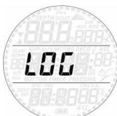
Der Smart Apnea kann, wenn ein Speicherintervall von 1 Sek. eingestellt ist, Tauchgangsprofile von etwa 20 - 30 Tauchstunden speichern, je nach Anzahl der Tauchgänge in einer Tauchgangsserie und der Dauer der einzelnen Tauchgänge.
