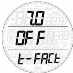
Die Mindestdauer der Oberflächenpause errechnet sich aus der Dauer des vorangegangenen Tauchgangs multipliziert mit dem T-Faktor. Der T-Faktor kann in Schritten von 0,5 auf einen Wert zwischen 1 und 7 eingestellt werden.
