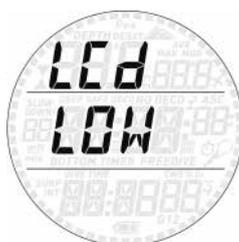
In diesem Menüpunkt können Sie eine niedrige (low) oder hohe (high) Bildfrequenz einstellen. Die Voreinstellung ist „low“: Dadurch wird der Stromverbrauch niedrig gehalten, aber bei sehr intensivem Licht können Sie evtl. ein leichtes Flimmern auf dem Display wahrnehmen. Die Einstellung „high“ verringert das Flimmern, verkürzt aber die Lebensdauer der Batterie um etwa 30 %.
