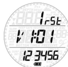
In diesem Untermenü werden Informationen über die Hardware und Software Ihres Smart Apnea und der Ladezustand der Batterie angezeigt. Zeigt das Batteriesymbol zwei Segmente, ist die Batterie in Ordnung; ein Segment bedeutet, dass die Batterie schwach ist, der Smart Apnea aber noch als Tauchcomputer funktioniert; blinkt das eine Segment, reicht die Batteriespannung nicht mehr zum Tauchen.
