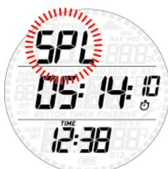
Die Stoppuhr hat auch eine Zwischenzeit-Funktion: Wenn Sie die untere Taste bei laufender Stoppuhr drücken, wird die Zeitanzeige angehalten, in der oberen Zeile blinkt **SPL** (split-time = Zwischenzeit) und die Zeitnahme läuft im Hintergrund weiter. Jeder Druck auf die untere Taste aktualisiert die angezeigte Zwischenzeit. Um die Zwischenzeit-Funktion zu verlassen, halten Sie die untere Taste gedrückt. Solange die Zwischenzeit-Funktion aktiv ist, ist die obere Taste funktionslos.
