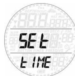
Um ein Menü zu öffnen, halten Sie die obere Taste gedrückt; um die verfügbaren Optionen nach oben oder unten zu rollen bzw. um einen vorgegebenen Wert zu vergrößern oder zu verkleinern, drücken Sie eine der Tasten. Um die geänderte Einstellung zu speichern, halten Sie dann die obere Taste gedrückt. Um im Menü eine Stufe zurückzugehen, halten Sie die untere Taste gedrückt.
