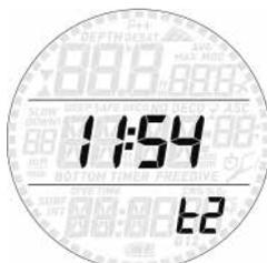
Der Smart Apnea verfügt über einen „Sleep“-Modus: Wenn Sie den Smart Apnea nur beim Tauchen tragen, können Sie ihn in den Sleep-Modus versetzen, um die Batterie zu schonen. Durch Drücken einer Taste beenden Sie den Sleep-Modus.
