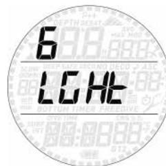
Bei schlechten Lichtverhältnissen können Sie am Smart Apnea die Displaybeleuchtung einschalten, indem Sie die untere Taste gedrückt halten. Während des Tauchgangs bleibt die Displaybeleuchtung so lange eingeschaltet, wie Sie es in diesem Menü eingestellt haben. Sie können einen Wert zwischen 1 und 10 Sekunden einstellen.
