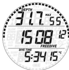
Kurzes Drücken der oberen Taste schaltet zur nächsten Tauchgangsserie, Gedrückt halten öffnet die Tauchgangsserie: Sie sehen für jeden einzelnen Tauchgang in der oberen Zeile die Maximaltiefe und die laufende Nummer des Tauchgangs, in der mittleren Zeile die Tauchzeit, und in der unteren Zeile abwechselnd die Dauer der Oberflächenpause vor dem Tauchgang, die maximale Aufstiegs- und Abstiegsgeschwindigkeit und die niedrigste Temperatur während des Tauchgangs.
