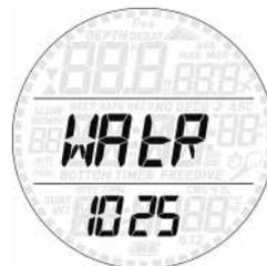
Anders als bei anderen Tauch- und Freitauchcomputern, die Ihnen nur die Wahl zwischen Süß- und Salzwasser lassen, können Sie im Smart Apnea für die Dichte des Wassers einen genauen Wert eingeben. Dieser kann in Schritten von 0,001 auf einen Wert zwischen 1,000 (Süßwasser) und 1,050 eingestellt werden. Die Voreinstellung von 1,025 entspricht der Salzwassereinstellung anderer Mares Tauchinstrumente.
