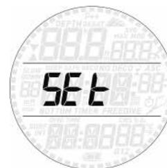
Im Menü **SEt** (Einstellungen) können Sie verschiedene Einstellungen ändern. Drücken Sie innerhalb dieses Menüs eine der Tasten, um zwischen den beiden Untermenüs umzuschalten: **SEt DIVE** (Tauchgangseinstellungen), wo sie die einzelnen Tauchgangsparameter einstellen können, und **SEt TIME** (Uhreinstellungen), wo Sie die einzelnen Einstellungen für die Uhr vornehmen können.
